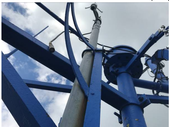
Urządzenia pomiarowe mocowane do ramy łukowej
