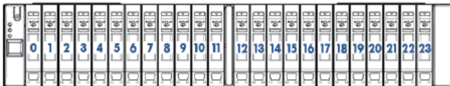
Numeracja dysków SFF w półce HP M6710 (2U24) lub półce z kontrolerami (widok z przodu)
