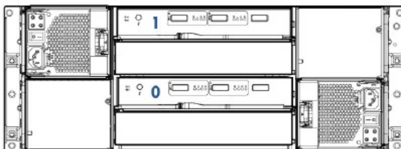
Numeracja modułów I/O w półce HP M6720 (4U24) (widok z tyłu)
