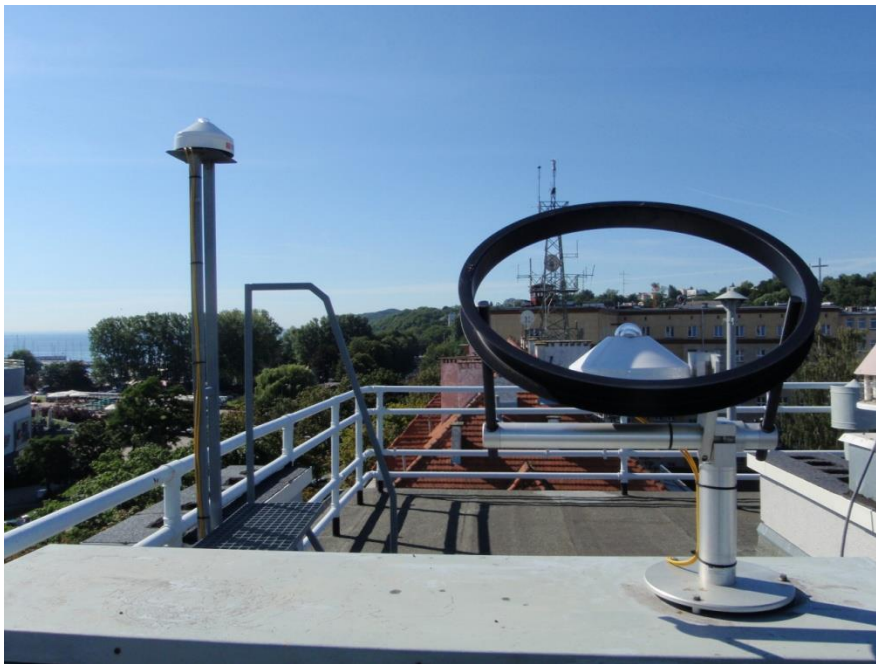
Zdj. 5 Pyranometr do pomiaru promieniowania całkowitego z lewej strony zdjęcia pyranometr z osłoną przeciwsłoneczną (dyfuzjometr) do pomiaru promieniowania rozproszonego
