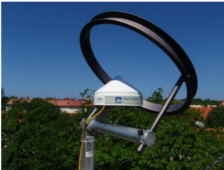
Zdj. 6 Pyranometr z osłoną przeciwsłoneczną (dyfuzjometr) zbliżenie
