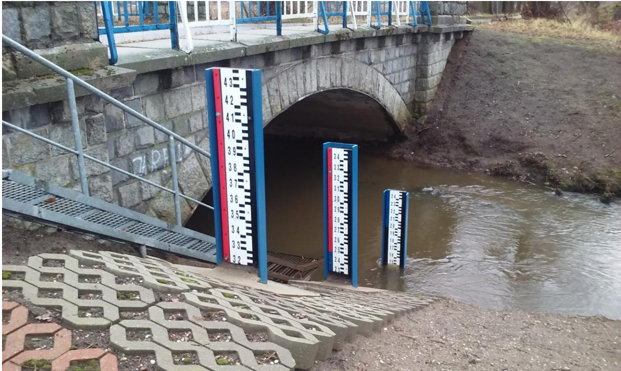
Fot 2. Fotografia poglądowa, posadowienie łat wodowskazowych w korycie rzeki.
