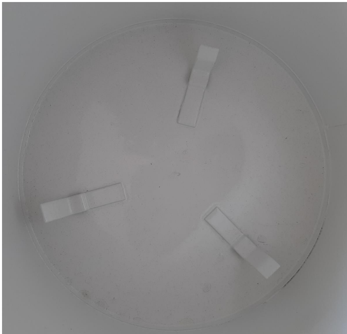
Rys 2. Dno podstawy deszczomierza Hellmanna. Widoczne trzy węży stabilizujące zbiornik wewnątrz podstawy.
