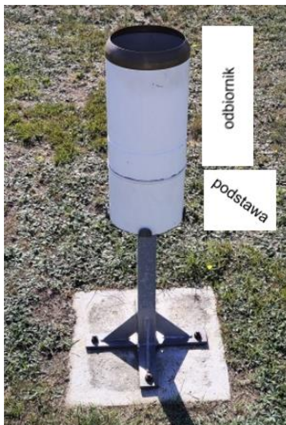
Rys. 1 a – Współczesny deszczomierz Hellmanna
