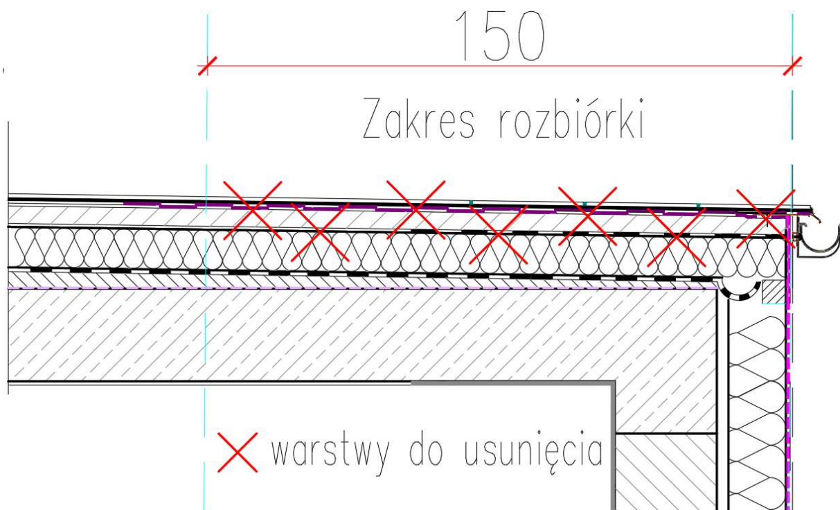
Rys. 19. Zakres prac remontowych- naprawczych na tarasie.
