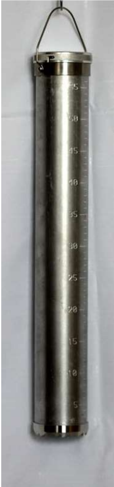
Fot. 1 Cylinder pomiarowy
